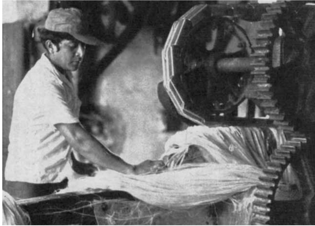
36). Proceso de raspado o desfibrado del henequén para obtener la fibra. (Littlefield, 1972).
